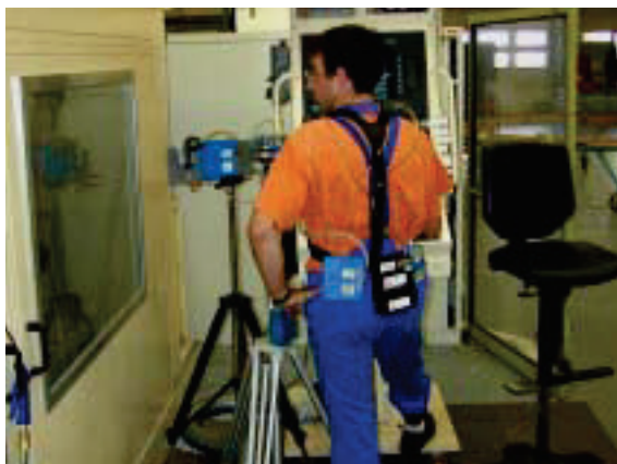
Bild 8: Expositionsmessungen personengetragen und am Bedienpult
