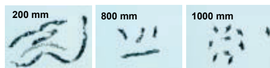
Bild 5: Variation der Vorschubgeschwindigkeit bei Einsatz des Schmierstoffes Ester 8 mit entstehender Spanform
