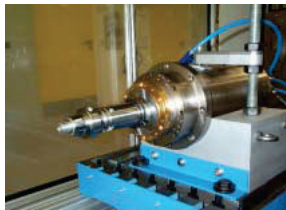
Bild 1: Spindelprüfstand mit HSC-Motorspindel für die innere Aerosolzufuhr
